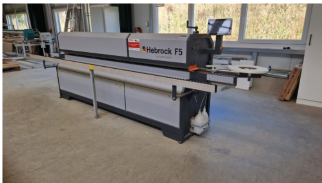
Kantenanleimmaschine Hebrock F5, eine PU-Verleimung ist möglich
